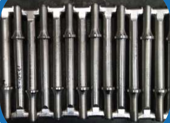
Punteras para equipos hidroneumáticos
